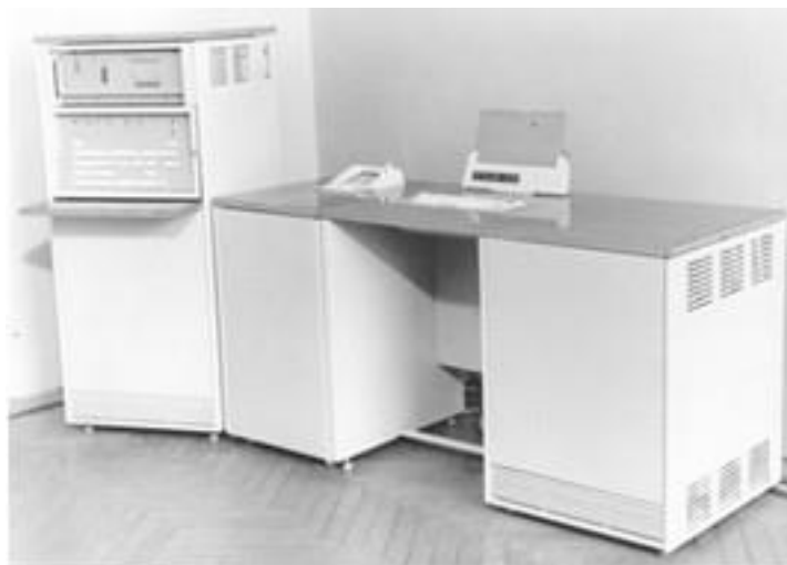
Цифрова спеціалізована машина "Київ-70" для еліонної технології виробництва ВІС (великих інтегральних схем). Головний конструктор В.П.Деркач
