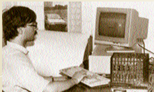
Первый в СССР нейрокомпьютер был разработан в 1988-1989 гг. на основе идеологии ансамблевых стохастических нейросетей. Руководитель работ Э.М. Куссиль. Отдел Н.М. Амосова. Первый макет нейрокомпьютера (1989 г.) был создан на отечественной элементной базе и представлял собой приставку к персональному компьютеру
