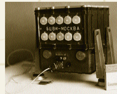
Бортовой компьютер «Москва». На его базе созданы бортовые компьютеры МИГ-1, МИГ-11, МИГ-12 МИГ-13 для систем управления космическими аппаратами. Института кибернетики АН УССР. Г.С. Голодняк, В.М. Петрунек
