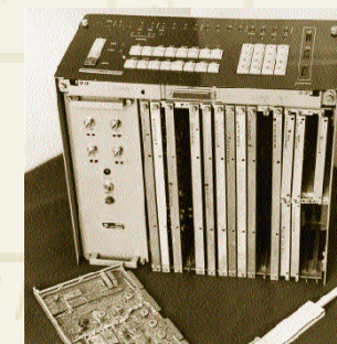
Электроника С5-01. Первенец семейства микрокомпьютеров общего назначения. Электроника С5 первого в бывшем СССР. КБ «Светлана» (г. Ленинград), Институт кибернетики АН УССР. 1974 г.
