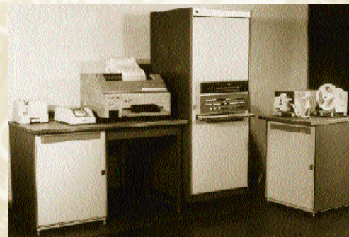
Вычислительная управляющая система М-6000 АСВТ-М (модернизированной). «Рабочая лошадка» во многих тысячах управляющих систем и комплексов различного назначения. 70-е гг. XX века
