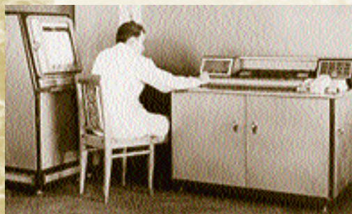
Феррит-транзисторная машина первичной переработки информации МППИ-1 трехуровневой системы оперативного управления производством СОУ-1. Начало 60-х гг. XX века
