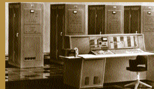
Компьютер второго поколения М-4М. Один из первых транзисторных компьютеров в бывшем СССР. Опытный образец заработал в конце 1960 г.
