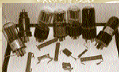
Детали Малой электронной счетной машины МЭСМ: электронные лампы, сопротивления, конденсаторы
