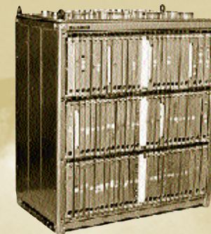
Мультипроцессорная вычислительная система 1801 ЗМ1Г для обработки гидроакустических сигналов на базе микропроцессоров 585. Разработка НИИ «Гидроприбор», В.Ю. Лапий, В.В. Крамской. Киев. 1984 г.
