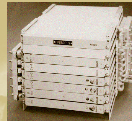
Специализированная отказоустойчивая вычислительная система для управления и обработки гидроакустической информации в составе гидроакустической станции «Нептун». Производительность 250 тыс. опер./сек. Вероятность безотказной работы 0,92 за 1 год. НИИ Гидроприбор. 1986 г.
