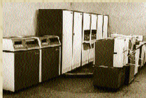
Высокопроизводительный вычислительный комплекс на БИС ПС-2100 производительностью 1,5 млрд. опер./с. 80-е гг. XX века
