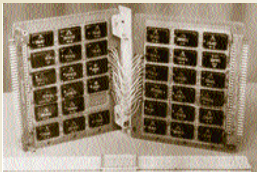
Кассета процессора компьютера «Карат» в развернутом виде. Видны многокристальные микросхемы «Вардува» (серия 240). 1971 г.
