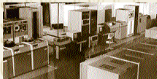
Региональный геофизический вычислительный комплекс ПС-3000. Производительность – 3 млрд. опер./с. Начало 90-х гг. XX века
