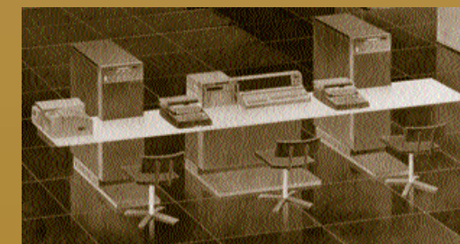
Пульт управления компьютера третьего поколения М-10. Он использовался как базовый компьютер в системе ПРО. 70 – 80-е гг. XX века
