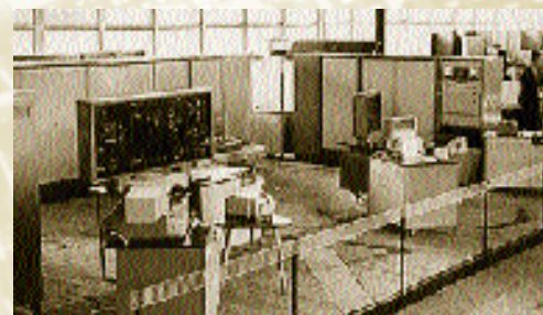
Феррит-транзисторная координирующая вычислительная машина КВМ-1 системы СОУ-1, объединяющая машины МППИ и УМ-1 в единую многоуровневую систему. 1968 г.
