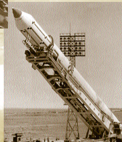
Ракета-носієв «Зеніт». Міжнародна презентація ракети-носія відбулася 1989 р. в Австралії. Пуски ракет-носіїв можуть здійснюватись в будь-який час доби, за будь-яких метеоумов за температури повітря від мінус 40 до плюс 50 градусів за Цельсієм. Ракета-носієв «Зеніт» використовувалась у міжнародному проєкті «Морський старт». 1989 р.
