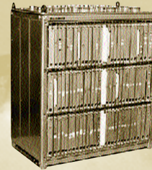
Мультимікропроцесорна обчислювальна система 1801 ЗМ1Г для обробки гідроакустичних сигналів на базі мікропроцесорів 585 серії. Розробка НДІ «Гідроприлад», В.Ю. Ланій, В.В. Крамской. Київ, 1984 р.
