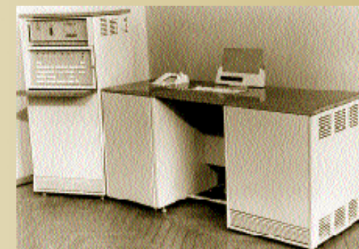
Цифровий спеціалізований комп'ютер «Київ-70», створений в Інституті кібернетики АН УРСР. Головний конструктор – В.П. Деркач. Використовувався при еліонній технології виробництва ВІС. В Інституті кібернетики з допомогою «Київ-70» були записані тексти з щільністю 110000 літер/мм 2 . За такої щільності 30 томів Великої радянської енциклопедії розмістились би на площі циферблата ручного годинника. 1970 р.
