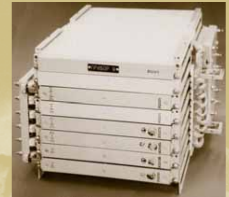
Спеціалізована відмовостійка обчислювальна система для керування й обробки гідроакустичної інформації в складі гідроакустичної станції «Нептун». Продуктивність 250 тис. опер./с. Імовірність безвідмовної роботи 0,92 за 1 рік. НДІ «Гідроприлад». 1986 р.
