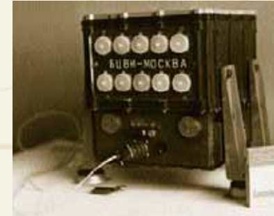
Сімейство бортових комп'ютерів «Москва». На його базі створені бортові комп'ютери «МИГ-1», «МИГ-11», «МИГ-12», «МИГ-13» для системи керування космічними апаратами. Інститут кібернетики АН УРСР. Г.С. Голодняк, В.М. Петрунук
