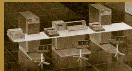
Пульт керування комп'ютера III покоління «М-10». Використовувався як базовий комп'ютер у системі ПРО. 70–80-ті рр. XX ст.
