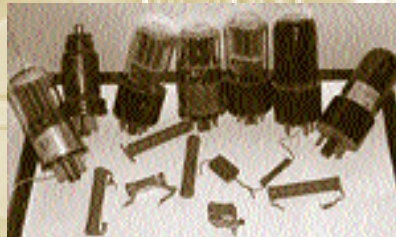
Деталі Малої електронної лічильної машини «МЭСМ»: електронні лампи, опори, конденсатори
