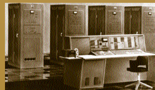
Комп'ютер II покоління «М-4М». Один з перших транзисторних комп'ютерів у колишньому СРСР. Дослідний зразок почав працювати у кінці 1960 р.
