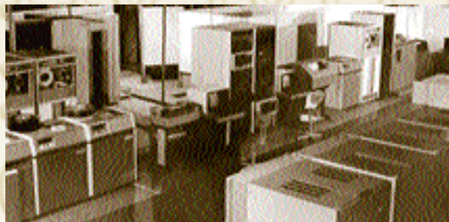
Регіональний геофізичний обчислювальний комплекс «ПС-3000», продуктивністю 3 млрд опер./с. Початок 90-х рр. XX ст.
