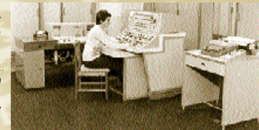
Ферит-транзисторна координуюча обчислювальна машина «КВМ-1» системи «СОУ-1», яка об'єднує машини «МППИ» та «УМ-1» в єдину багаторівневу систему. 1968 р.
