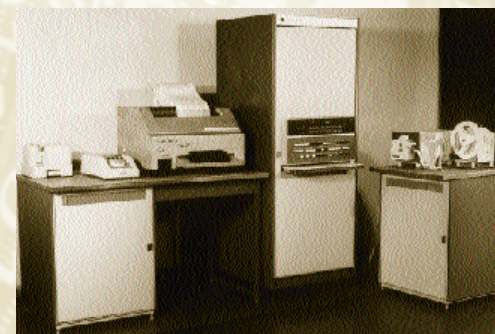
Обчислювальна керуюча система «М-6000» системи «АСВТ-М» (модернізованої). «Робоча конячка» в багатьох тисячах керуючих системах і комплексах різноманітного призначення. 70-ті рр. XX ст.
