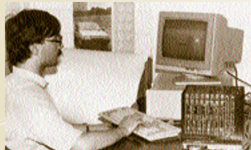
Перший у СРСР нейрокомп'ютер було розроблено у 1988–1989 рр. на основі ідеології ансамблевих стохастичних нейромереж. Керівник робіт Е.М. Куссуль. Відділ М.М. Амосова. Перший макет нейрокомп'ютера (1989 р.) був створений на вітчизняній елементній базі та являв собою приставку до персонального комп'ютера
