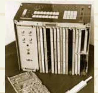
«Електроніка С5-01». Первісток сімейства мікрокомп'ютерів загального призначення «Електроніка С5» – першого в колишньому СРСР. КБ «Світлана» (м. Ленінград), Інститут кібернетики АН УРСР. 1974 р.
