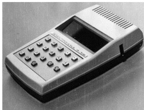
Первый в Европе микрокалькулятор, разработанный в НИИ "Микроприбор" (промышленный образец) 1970 год
