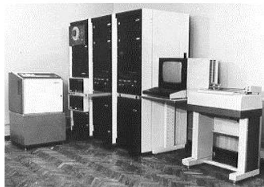
Двухпроцессорный управляющий вычислительный комплекс СМ2М системы СМ ЭВМ
