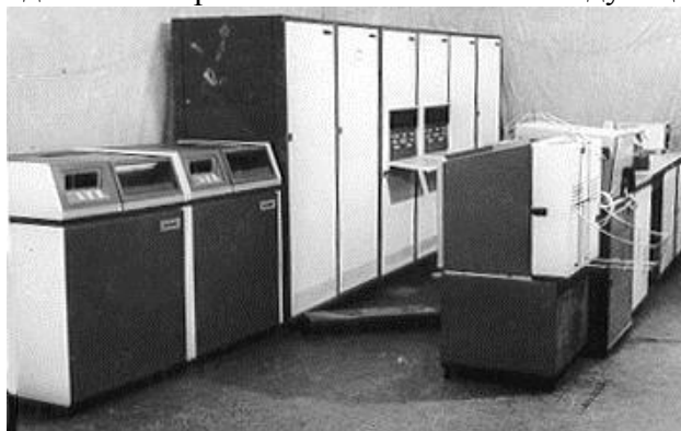
Двухпроцессорный управляющий комплекс М-7000 системы АСВТ-М
