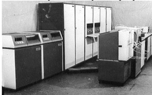
Двопроцесорний керуючий комплекс "М-7000" системи "АСВТ-М"
