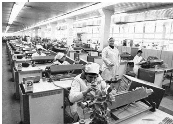
Автоматизована ділянка монтажу (накруткою) для складальних панелей СМ ЕОМ
